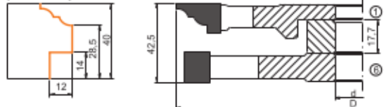
profil wzdłużny świetlika
